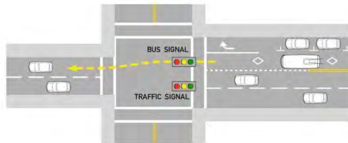
Figure 43 : Marquage de la chaussée d'un SRB lors de l'insertion en site banal 4
